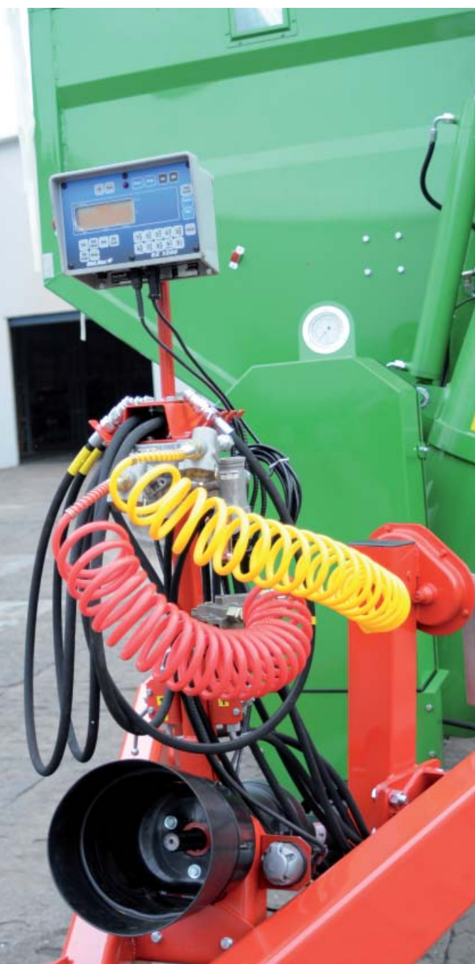
System wagowy z wyświetlaczem pokazuje na bieżąco masę zboża w zbiorniku
