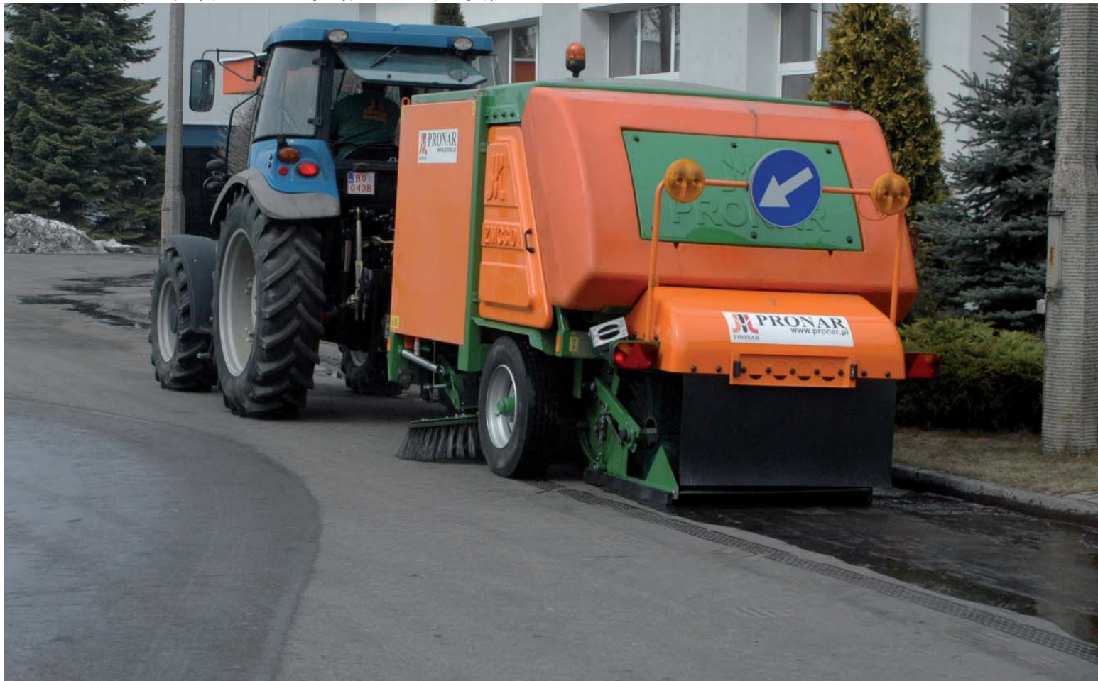
Zamiatarka ZMC 3.0 podczas pracy; pozostawienie wilgotnej powierzchni zapobiega pyleniu
