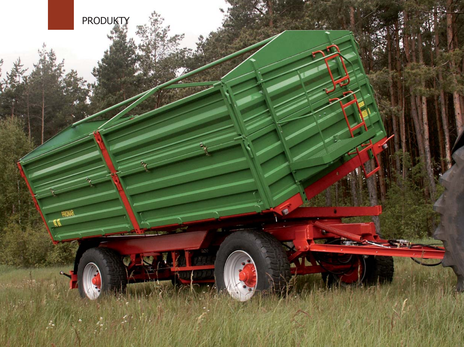
Skrzynia ładunkowa przyczepy PRONAR T672 przechyla się maksymalnie pod kątem 50 stopni
