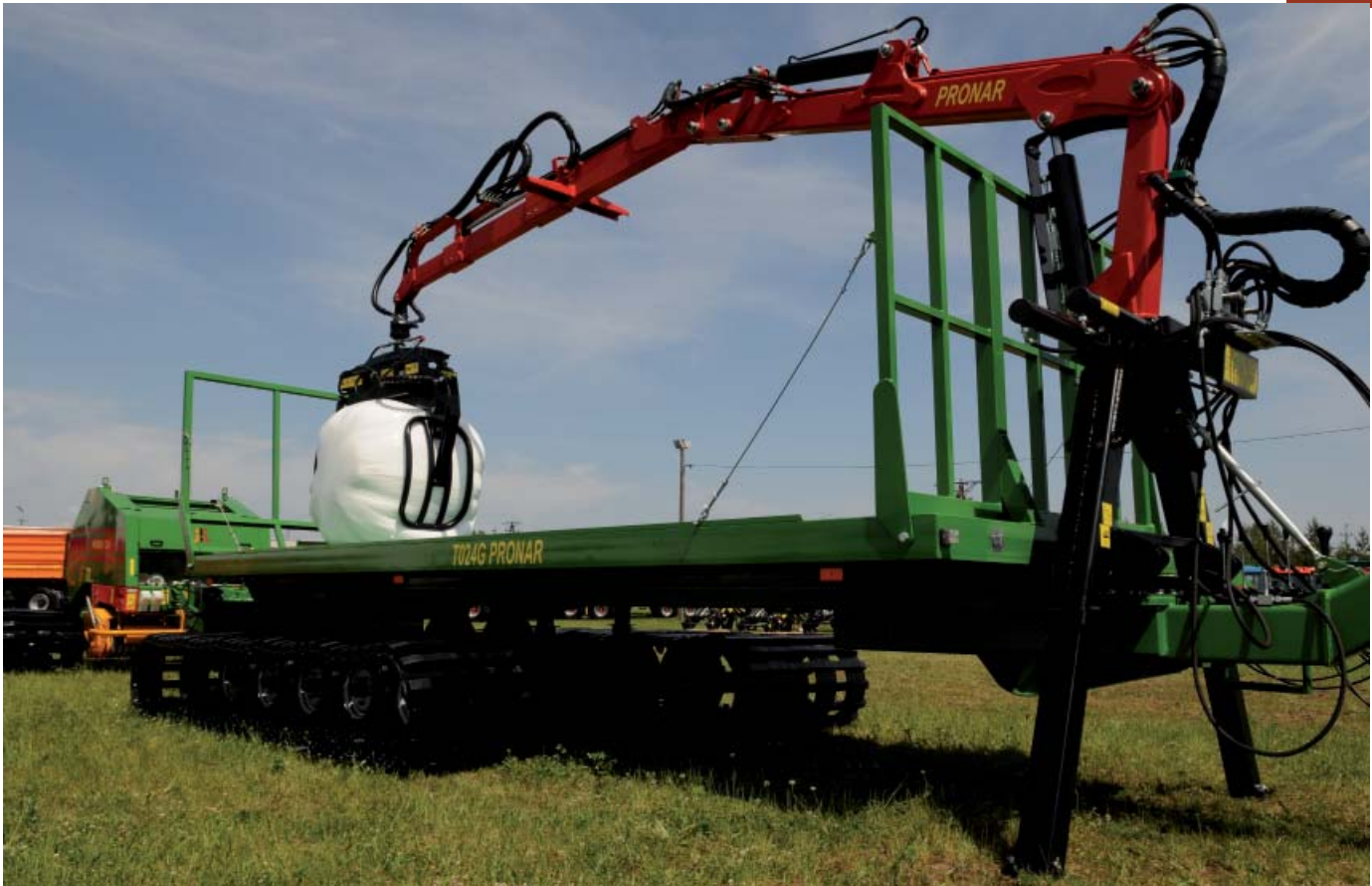
Ładowacz PRONAR ŁZP6900 można agregować z różnymi przyczepami, np. z PRONAR T024G, przeznaczoną do pracy na terenach podmokłych. Wysuwane podpory ładowacza zapewniają mu stabilność
