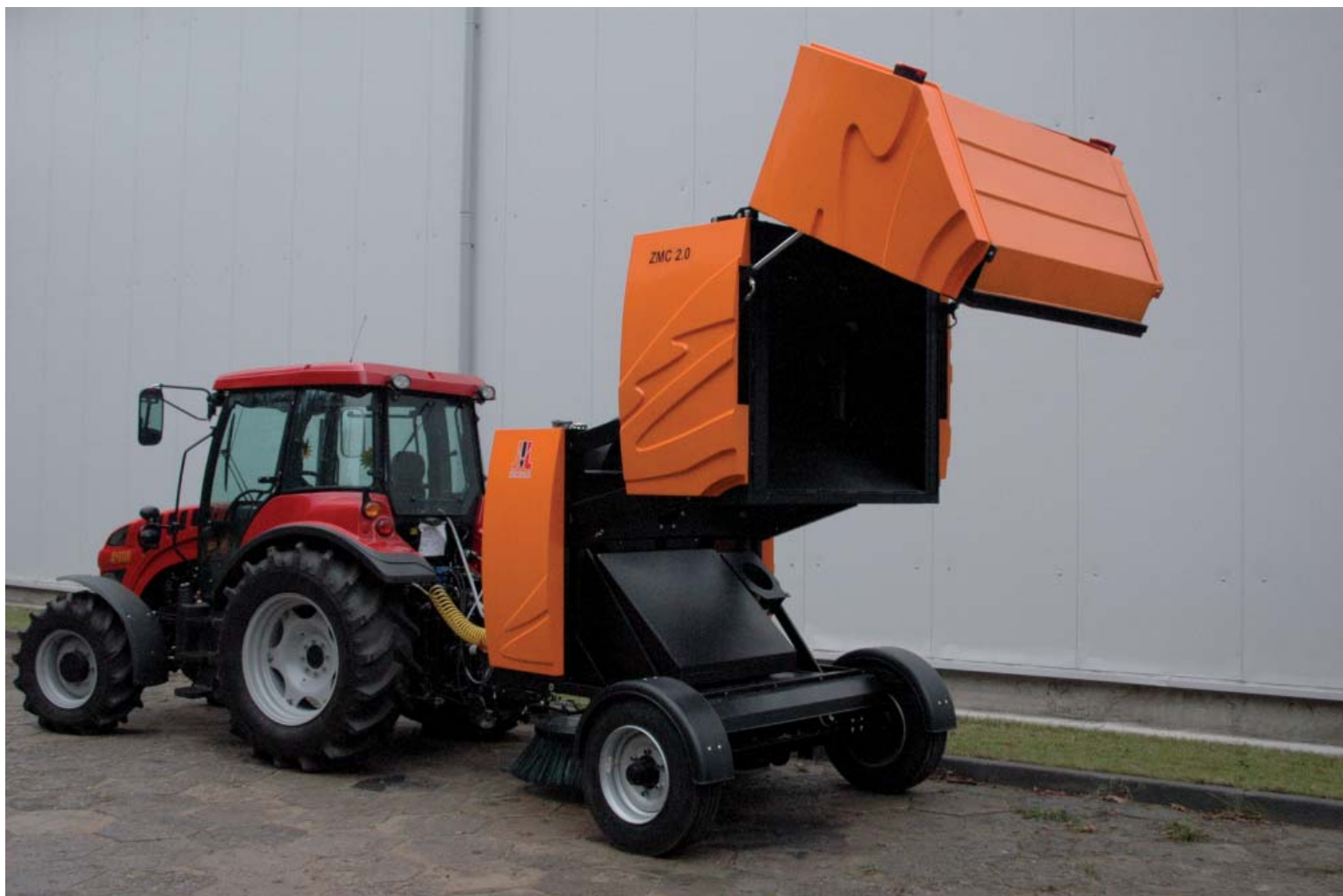
Opróżnianie zbiornika zanieczyszczeń zamiatarki ZMC 2.0 odbywa się w sposób hydrauliczny z kabiny operatora
