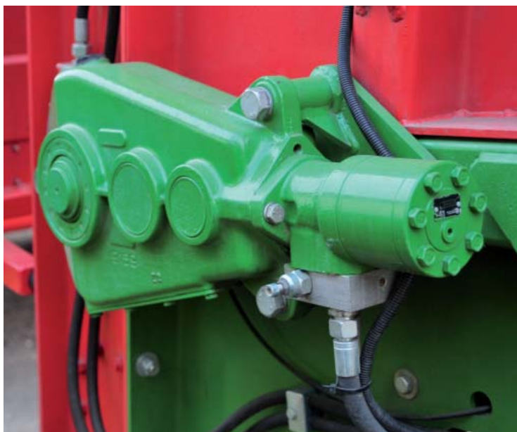
Przekładnia napędzana silnikiem hydraulicznym, która napędza posuw przenośnika podłogowego, zapewniając precyzję w dozowaniu dawki nawozu
