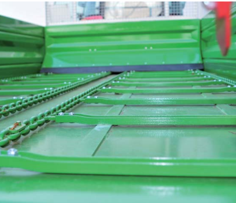
W rozrzutniku PRONAR N161 nawóz ze skrzyni ładunkowej transportowany jest mechanizmem zbudowanym z czterech łańcuchów, powiązanych ze sobą listwami zgarniającymi. Przykręcany system mocowania listew pozwala na ich szybką wymianę
