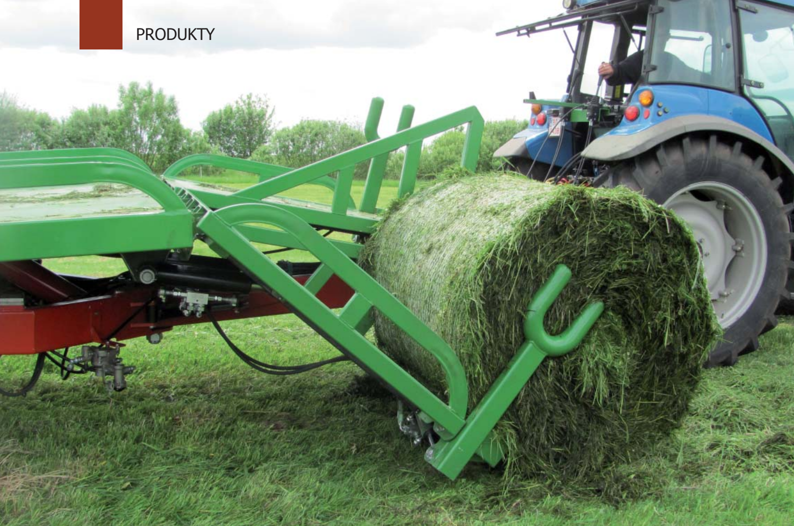
Chwytywanie i załadunek beli. Sterowanie odbywa się za pomocą dźwigni z kabiny ciągnika
