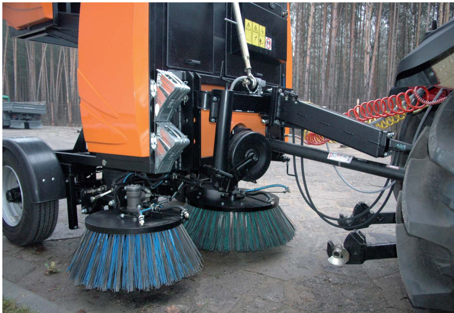
Zespół zmiatający zmiatarki ZMC 2.0 składa się z dwóch szczotek podmiatających oraz końcówki zasysającej zanieczyszczenia
